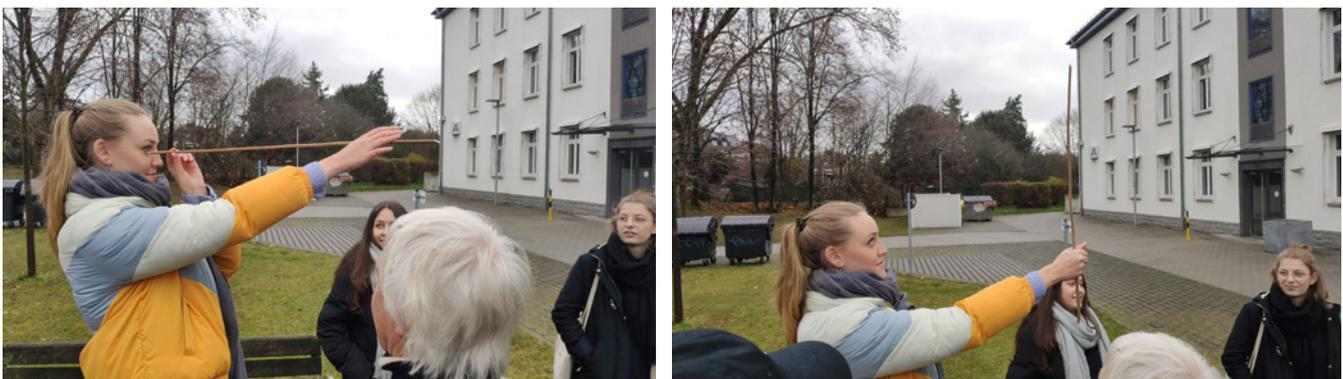
Bild 2: Anwendung des Försterdreiecks zur Bestimmung der Regenrinnenhöhe
